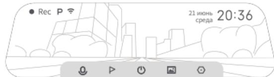
После включения видеорегистратора запись видео начнется автоматически. Красная мигающая точка в левом верхнем углу экрана обозначает выполнение записи видео.
